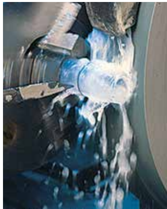
NS-Kerne werden auf halbautomatischen Rundschleifmaschinen weiterbearbeitet.
