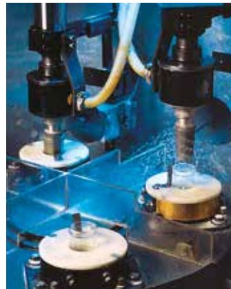
Das Vor- und Fertigreiben von NS-Hülsen erfolgt auf Mehrstationen-Anlagen.
