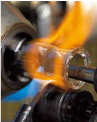
Produktion von Schliff-Rohlingen aus DURAN®-Rohr auf vollautomatischen Glasverformungsmaschinen.
